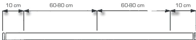
Les dimensions indiquées sont données à titre d'information. Les distances entre supports sont variables et dépendent de la masse et de l'amplitude de la tenture à suspendre.
